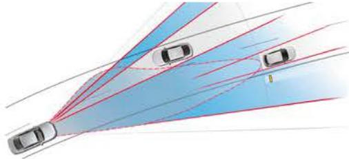
bestehend aus Tagfahrlicht, Abblendlicht, Fernlicht, Positionslight, dynamischem Blinklicht vorn und hinten, Abbiegelicht, Allwetterlicht, Autobahnlicht, Rangierlicht, dynamischem Kurvenlicht und Kreuzungslicht
