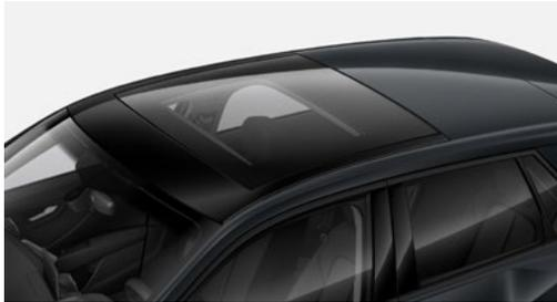
Das Panorama-Glasdach überzeugt durch eine komfortable Bedienung. Ausstellen und Öffnen des Glaselements erfolgen elektrisch. Die Sonnenrollos sind stufenlos manuell einstellbar. Von außen kann mit dem Funkschlüssel mittels Komfortöffnung und -schließung das Panorama-Glasdach mitbedient werden. Geöffnet verbessert das Panorama-Glasdach das Innenraumklima durch effiziente Entlüftung. Ein integrierter Windabweiser reduziert dabei die Windgeräusche.
