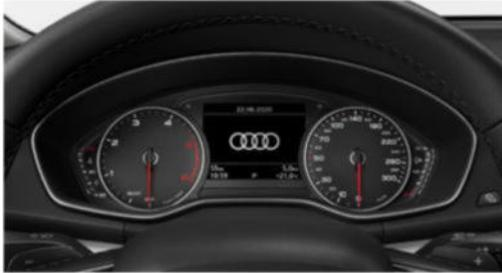
Die Fahrerinformationen werden im 5-Zoll-Monochromdisplay auf der Instrumententafel angezeigt. Neben den grundlegenden Fahrzeuginformationen erfolgt auch die Anzeige zusätzlicher optionaler Funktionen wie Telefonmenü und Navigation. Zudem werden Hinweise für eine ökonomische Fahrweise angezeigt.
