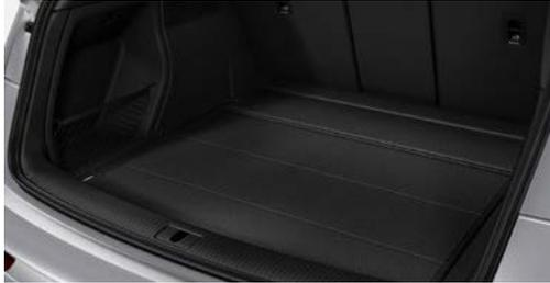
in mehreren Segmenten falt- und klappbar; benutzbar in voller Länge zur Abdeckung des Gepäckraumbodens auch bei umgeklappter Rücksitzlehne, Verwendung zur variablen Unterteilung des Laderaums; Schutzlänge ausreichend auch für die Ladekante und den Stoßfänger
