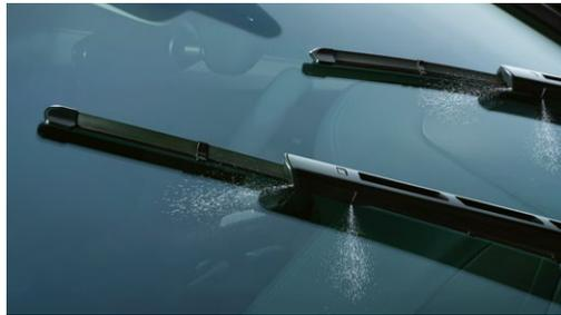
Das Adaptive Scheibenwischer System ermöglicht eine Verbesserung der Sicht bei jedem Wetter. Die Reinigungsflüssigkeit wird direkt vor die Wischerblätter gesprüht und nahezu ohne Verzögerung weggewischt, sodass auch während des Wischvorgangs die Sicht möglichst frei bleibt. Das System ist beheizbar.
