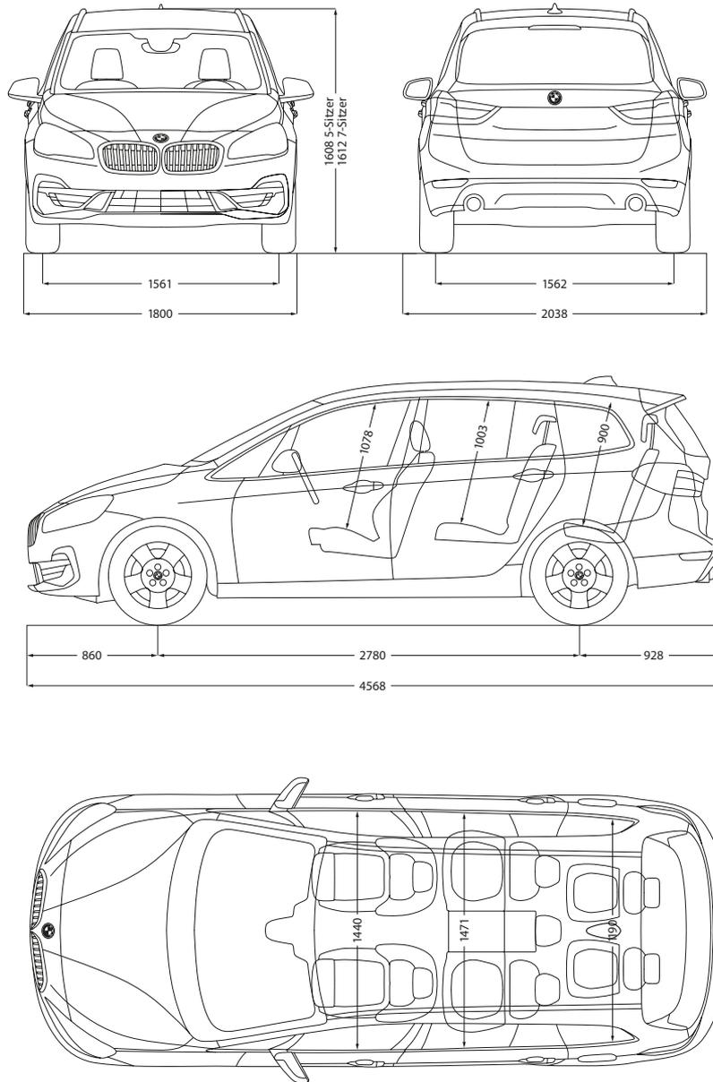
Alle Maßangaben der technischen Zeichnung in Millimeter. Werte in [ ] gelten für Fahrzeuge mit Steptronic Getriebe.
