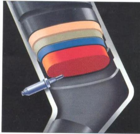
**Modernste Umwelttechnologie. Jeder BMW der 3er-Reihe (Benzinmotor) ist serienmäßig mit einem geregelten Dreifach-Katalysator ausgerüstet. Bei**
