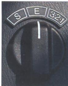
**Automatisch optimal. Für die 6-Zylinder-Modelle ist auf Wunsch eine Automatic mit elektronisch-hydraulischer (EH-) Steuerung und drei Fahrprogrammen lieferbar: wirtschaftlich, sportlich, manuell (nur „Benziner“).**
