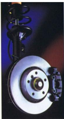
**Reinporttechnologie für jeden Tag:** Beim BMW M3 sorgen die Hochleistungsbremsen an den Vorderrädern für eine bislang unerreichte Standfestigkeit. Dank ihrer besonderen Konstruktion bietet die Compound-Bremscheibe eine überragende Bremsleistung auch bei extremer Beanspruchung. Sie ist erheblich
