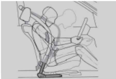
■ **BMW Rückhaltesystem** für Fahrer, Beifahrer und die äußeren Fondpassagiere besteht aus einer Kombination von 3-Punkt-Sicherheitsgurt, Gurtstrammer und Gurtkraftbegrenzer. So ist bestmögliche Rückhaltewirkung bei einer Kollision garantiert.
