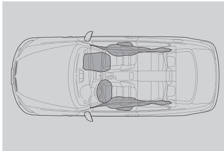
■ **Airbags** und alle weiteren Sicherheitskomponenten sind in einem BMW optimal aufeinander abgestimmt. So wird bei einer Kollision nur der Airbag ausgelöst, der auch benötigt wird. Sechs Airbags bieten gezielten Schutz: Fahrer- und Beifahrerairbags, durchgehende Kopfairbags vorn und hinten sowie Seitenairbags vorn.
