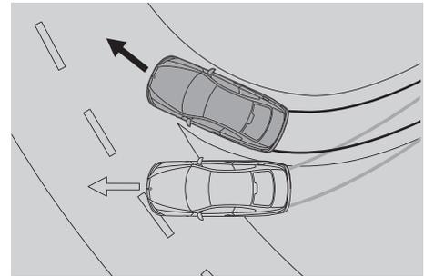
■ **Dynamische Stabilitäts Control (DSC)**, inkl. CBC und DBC (Dynamische Bremsen Control), mit erweiterten Funktionen. DSC erkennt eine Schleuderneigung im Ansatz und stabilisiert das Fahrzeug in Millisekunden. Die Unterfunktion Traktionsmodus (DTC) erlaubt erhöhten Radschlupf, um situationsabhängig den Vortrieb zu optimieren und sportlicheres Fahren zu ermöglichen.
