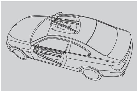
■ **Türverstärkungen** bieten bei einem seitlichen Crash höchstmöglichen Insassenschutz. So genannte Traversen (Verstärkungsprofile) werden hierzu diagonal und horizontal in die Türen eingesetzt – für eine sehr hohe Türsteifigkeit.
