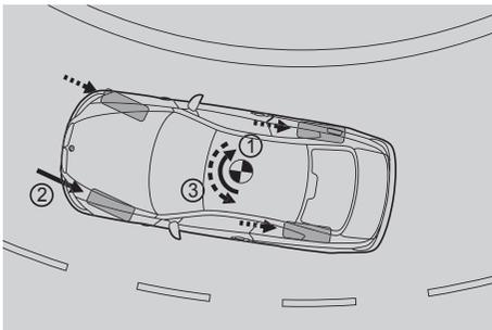
■ **Cornering Brake Control (CBC)** erhöht die Fahrstabilität beim leichten Bremsen in schnell gefahrenen Kurven. Die hinteren Räder werden beim Bremsen entlastet, was in Kurven zum Eindrehen des Fahrzeugs führen kann (1). CBC wirkt dem entgegen, indem es beim Bremsen außerhalb des ABS-Regelbereiches durch asymmetrische Regelung des Bremsdrucks (2) ein stabilisierendes Gegenmoment (3) erzeugt.
