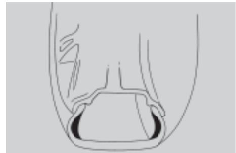
■ **Reifen mit Notlaufeigenschaften** sind Serie. Durch verstärkte Flanken sinken die Reifen selbst ohne Luftdruck nicht völlig ein und können nicht von der Felge springen. Die serienmäßige **Reifen Pannen Anzeige** minimiert die Gefahr bei einem Reifendefekt. Leichten Druckabfall signalisiert eine Leuchte im Cockpit, starken Druckabfall zusätzlich eine akustische Warnung.
