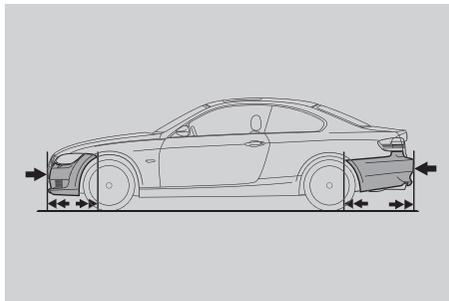
■ **Stoßfänger** mit reversiblen Alu-Pralldämpfern vorn (Stahldämpfer hinten) verkraften Stöße bis 4 km/h schadlos; spezielle Verformungszonen vorn und hinten nehmen Kräfte bis 15 km/h auf, ohne die Karosserie zu beschädigen.
