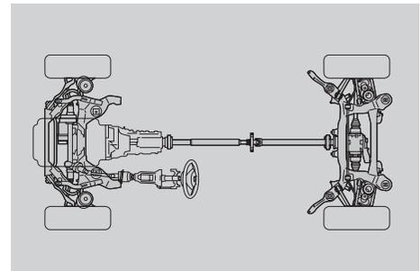
■ **Leichtbaufahrwerk** mit Doppelgelenk-Federbein-Vorderachse und Fünflenker-Hinterachse; für hervorragenden Bodenkontakt und höchste Fahrsicherheit bestehen viele Fahrwerksbauteile aus Aluminium.
