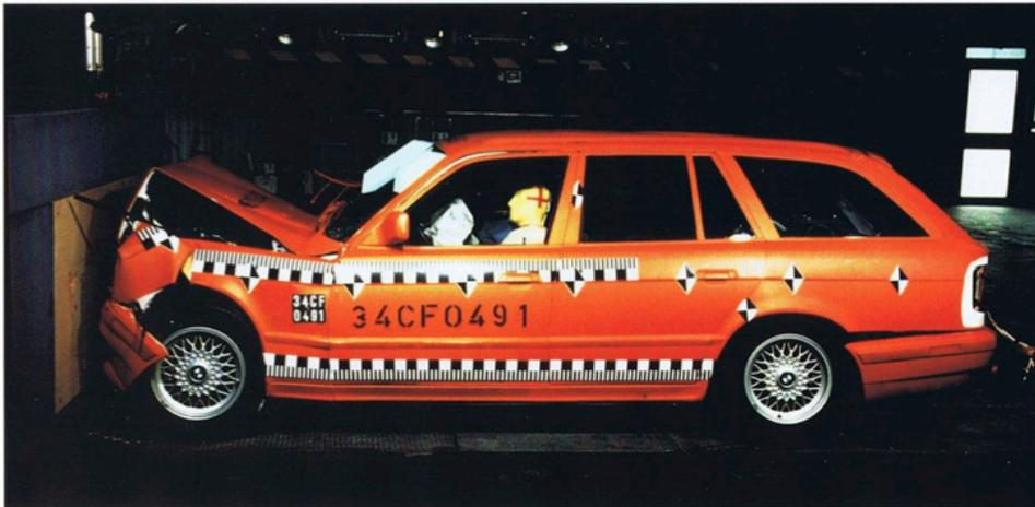
die passive Sicherheit bei einem Unfall. So sind der äußerst steifen Fahrgastzelle computerberechnete Verformungszonen vorgelagert. Im Falle eines Crashes nehmen diese zum Schutz der Insassen die Aufprallenergie gezielt auf. Ganz nach dem Grundsatz: Der Klügere gibt nach.
