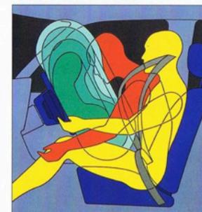
*Als ideale Ergänzung zum Sicherheitsgurt schützt ein Airbag (auf Wunsch) den Fahrer vor Verletzungen. Dieses System entfaltet sich bei einem Frontalaufprall binnen weniger Hundertstelsekunden und fängt Kopf und Oberkörper sicher auf.*
