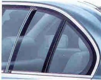
Weniger beschlagene Scheiben: Mit Doppelverglasung werden Temperatureinflüsse von außen reduziert.
