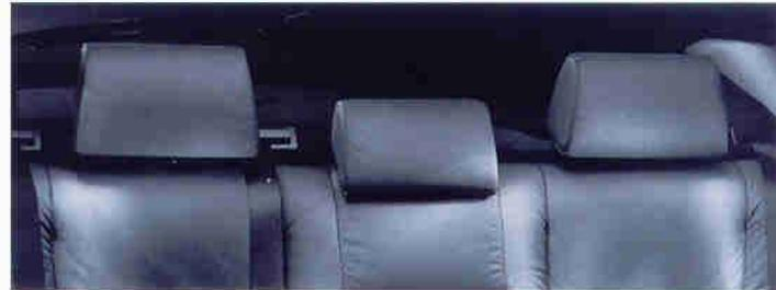
Die drei Kopfstützen im Fond sind höhenverstellbar. Zur besseren Sicht nach hinten ist die mittlere abgesenkt.
