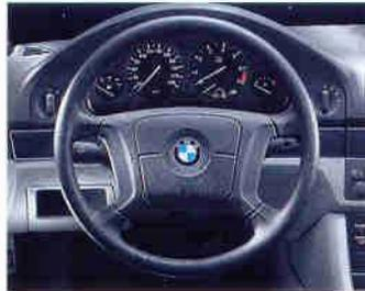
Lenksäule mit mechanischer Längs- und Höhenverstellung.
