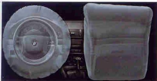
Insassenschutz durch Fahrer- und Beifahrer-Airbag. Der Beifahrersitz hat eine Sitzbelegungserkennung.
