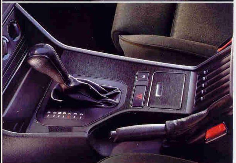
nach vorne, und das Getriebe schaltet in den nächsthöheren Gang, kurzes Antippen nach hinten, das Getriebe schaltet sanft zurück. Die ideale Möglichkeit für jeden, der schalten will, aber aufs Kuppeln verzichten möchte. Im Automa-
