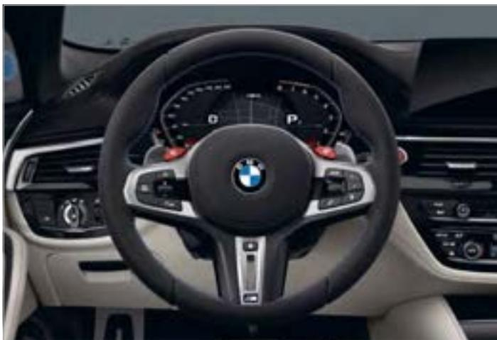
M Lederlenkrad mit Schaltwippen und M1 und M2 Tasten
