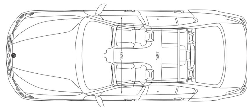
Alle Maßangaben der technischen Zeichnung in Millimeter. Höhe ohne Dachantenne beträgt 1466 mm. Angaben zu Fahrleistung, Verbrauch und CO<sub>2</sub>-Emission gelten für Fahrzeuge mit Seriengertriebe.
