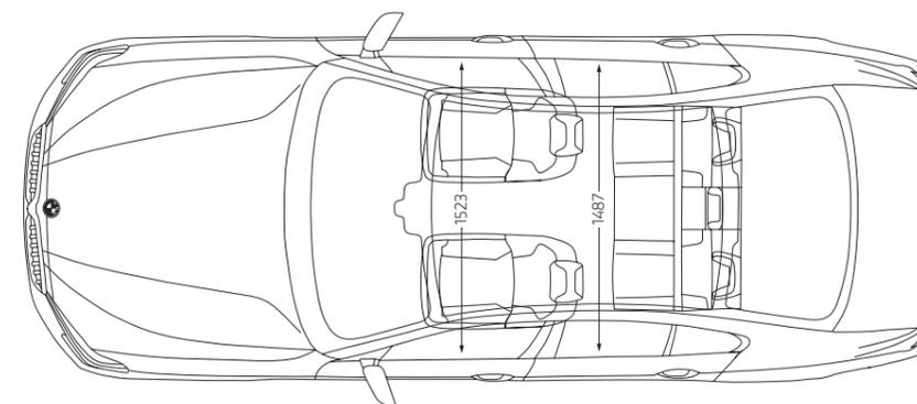
Alle Maßangaben der technischen Zeichnung in Millimeter. Höhe ohne Dachantenne beträgt 1466 mm. Angaben zu Fahrleistung, Verbrauch und CO<sub>2</sub>-Emission gelten für Fahrzeuge mit Seriengeräte.
