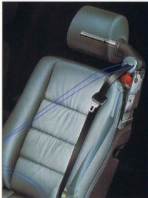
Beim **sitzintegrierten Gurtsystem** fahren alle Gurtumlenkpunkte bei der Sitzverstellung mit. So wird unabhängig von Körpergröße und Sitzposition eine sehr gute Rückhaltewirkung und dadurch deutlich verbesserter Schutz erreicht.
