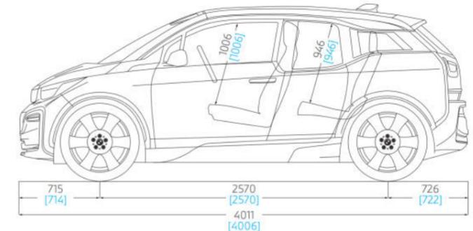
Die Maße für den BMW i3. Die Werte in [ ] gelten für den neuen BMW i3s. Alle Maßangaben der technischen Zeichnungen in Millimeter. Gepäckraumvolumen 260–1100 Liter. Die Höhe des BMW i3 mit Dachfinne beträgt 1598 mm. Die Höhe des BMW i3s mit Dachfinne beträgt 1590 mm.
