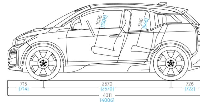
Die Maße für den BMW i3. Die Werte in [ ] gelten für den BMW i3s. Alle Maßangaben der technischen Zeichnungen in Millimeter. Gepäckraumvolumen 260 – 1.100 Liter. Die Höhe des BMW i3 mit Dachfinne beträgt 1598 mm. Die Höhe des BMW i3s mit Dachfinne beträgt 1590 mm.
