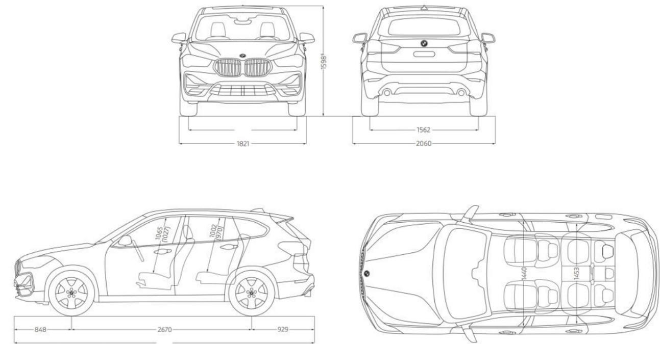
Alle Maßangaben der technischen Zeichnungen in Millimeter. Werte in [ ] in Verbindung mit Panorama-Glasdach. Angaben in [ ] gelten für Fahrzeuge mit Steptronic Getriebe.
