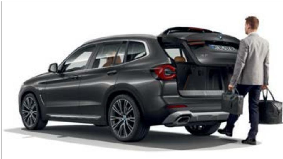
□ Der Komfortzugang<sup>1</sup> ermöglicht Ihnen den schlüssellosen Zugang zum Fahrzeug über alle Türen und die Heckklappe. Bei Annäherung wird zudem die Welcome-Inszenierung aktiviert, bevor sich die Türen automatisch entriegeln.
