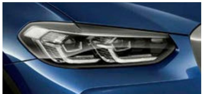
□ Der Adaptive LED-Scheinwerfer beinhaltet eine Abblend- und blendfreie Fernlichtfunktion (BMW Selective Beam) sowie Fahrtrichtungsanzeiger in Voll-LED-Technologie. Außerdem umfasst die Ausstattung Abbiegelicht, Tagfahrlicht und Adaptives Kurvenlicht mit variabler Lichtsteuerung für eine optimale Ausleuchtung der Fahrbahn und bessere Sicht bei Dunkelheit.
