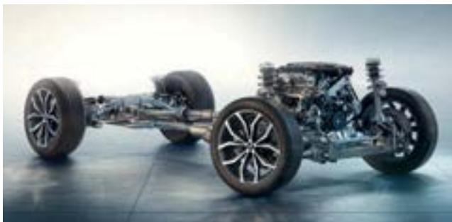
□ Das Adaptive Fahrwerk ermöglicht es, die Charakteristik der Dämpfer stets der jeweiligen Fahrsituation ideal anzupassen, den Abrollkomfort des Fahrzeugs zu erhöhen und zudem die Fahrdynamik zu verbessern. Neben der Standard-Einstellung COMFORT für hohen Fahrkomfort steht das Programm SPORT für eine sportive Dämpferauslegung des Systems zur Wahl.
