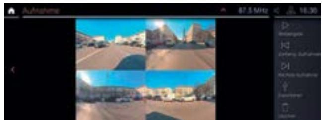
□ Der BMW Drive Recorder, bestehend aus dem Event- und dem Crashrecorder, ermöglicht die Aufnahme eines Videos von der Fahrzeugumgebung und das Abspielen des Videos auf dem Control Display oder über USB-Export auf Ihrem Endgerät. Wichtige Fahrzeuginformationen wie z. B. Geschwindigkeit und GPS-Position werden synchron mit dem Video gespeichert.
