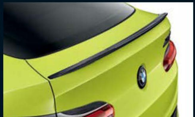
□ Der M Carbon Heckspoiler<sup>2</sup> betont die Exklusivität sowie das kraftvoll-sportliche Design des Fahrzeugs und reduziert spürbar unerwünschten Auftrieb an der Hinterachse.
