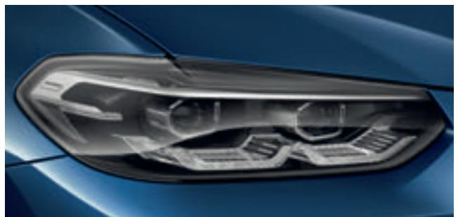
■ Der serienmäßige Adaptive LED-Scheinwerfer beinhaltet eine Abblend- und blendfreie Fernlichtfunktion (BMW Selective Beam) sowie Fahrtrichtungsanzeiger in Voll-LED-Technologie. Außerdem umfasst die Ausstattung Abbiegelicht, Tagfahrlicht und Adaptive Kurvenlicht mit variabler Lichtsteuerung für eine optimale Ausleuchtung der Fahrbahn und bessere Sicht bei Dunkelheit.
