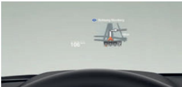
□ Das vollfarbige BMW Head-Up Display<sup>3</sup> blendet per optischer Projektion alle für die Fahrt relevanten Daten in das Sichtfeld des Fahrers ein und steigert damit die Konzentration auf das Fahrgeschehen. So werden hier ausstattungsabhängig die aktuelle Geschwindigkeit, Navigationshinweise, die Speed Limit Info inkl. Überholverbotsanzeige und Telefon- und Entertainmentlisten angezeigt.
