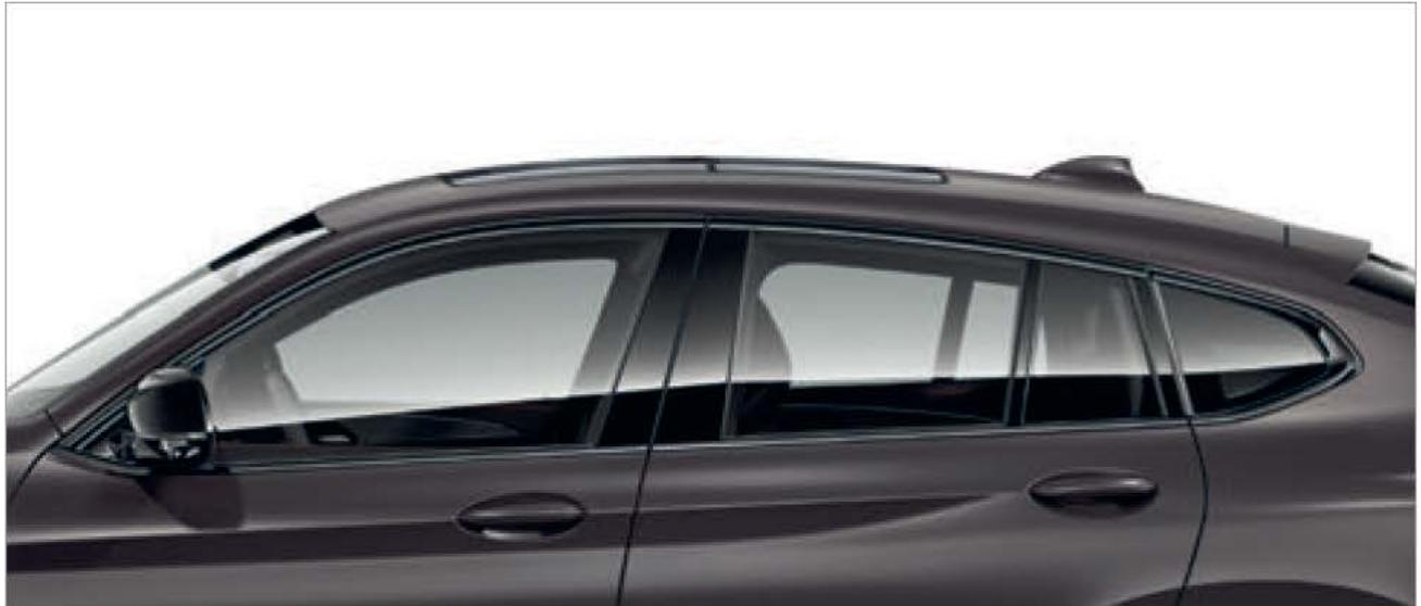
□ Die M Hochglanz Shadow Line<sup>2,3</sup> enthält zahlreiche Ausstattungsdetails in Schwarz hochglänzend: die Zierleisten der Seitenrahmen, die Fenster-schachtabdeckungen, die Außenspiegelrahmen, Spiegelfuß und -dreieck, die Blenden der B-Säulen sowie die Fensterführungsstege der hinteren Türen.
