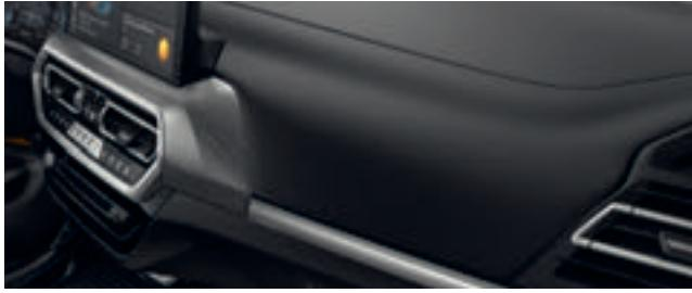
□ Die mit Sensatec bezogene Instrumententafel<sup>1</sup> verleiht dem Interieur des Fahrzeugs eine hochwertige Anmutung. Das direkt auf einen Halbhartschaum kaschierte Kunstleder überzeugt durch seine weiche Oberfläche. Der widerstandsfähige Bezug ist mit attraktiven Doppelkappnähten um die Türbrüstungen vorn und hinten versehen.
