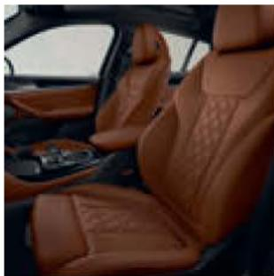
■ Die anpassbaren Sportsitze für Fahrer und Beifahrer zeichnen sich durch zahlreiche manuelle Einstellmöglichkeiten aus, darunter die Sitzlänge plus die Lehnen- und Sitzneigung. Dank höherer Sitz- und Lehnenwangen sowie ausgeprägter Seitenwangen bieten sie exzellente Ergonomie und hohen Seitenhalt.
