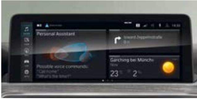
□ Das BMW Live Cockpit Professional<sup>1</sup> mit Navigationsfunktion beinhaltet einen hochwertigen Anzeigenverbund, bestehend aus einem per Touch bedienbaren hochauflösenden 12,3" großen Control Display und einem volldigitalen 12,3" großen Instrumentendisplay. Das BMW Operating System 7 kann u. a. über den BMW Touch Controller bedient werden.
