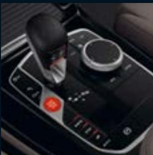
■ Im griffgünstigen Bedienfeld Mittelkonsole können Sie unterhalb des Start-/Stopp-Knopfs mit der M MODE Taste die Anzeigeninhalte verändern. Noch mehr Auswahl zur Konfiguration der Fahrzeugcharakteristik bietet die SETUP-Taste. Sie öffnet das Menü für individuelle Abstimmungen an der Fahrdynamik. Weitere Tasten schalten einzelne Assistenzsysteme ab oder zu.
