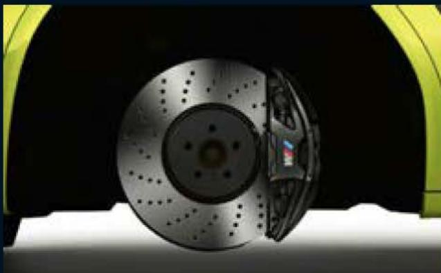
□ Durch den Einsatz unterschiedlicher Materialien erreicht die M Compound-Bremse<sup>1</sup> neben hervorragenden Verzögerungswerten eine hohe Standfestigkeit und lange Lebensdauer sowie eine Gewichtsreduzierung, die sich positiv auf Agilität, Dynamik und Beschleunigung auswirkt. Die Bremssättel in Schwarz hochglänzend mit M Logo kennzeichnen die M spezifische Hochleistungsbremsanlage.
