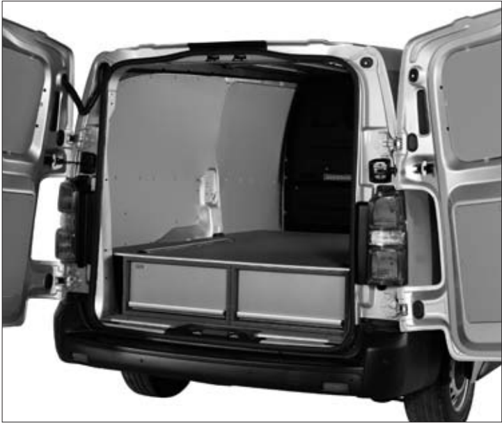
Die Abbildungen zeigen die Stauschubladen im Unterboden der Workline-Solution.
