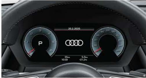
Mit dem Audi virtual cockpit plus steht ein innovatives, volldigitales Kombiinstrument zur flexiblen und bedarfsgerechten Anzeige von Informationen zur Verfügung. Das 12,3-Zoll-Display hat eine Auflösung in Full-HD-Qualität. Angezeigt werden können entsprechend den Fahrerbedürfnissen Geschwindigkeit, Drehzahl, Kartendarstellung, Audi connect-Dienste<sup>35</sup>, Radio- und Media-Informationen und vieles mehr.
