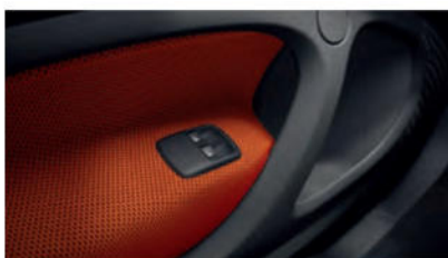
Fensterheber elektrisch mit Komfortbetätigung und Einklemmschutz
