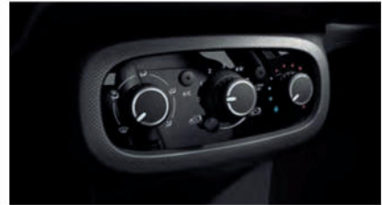
Klimaanlage manuell [I77]
