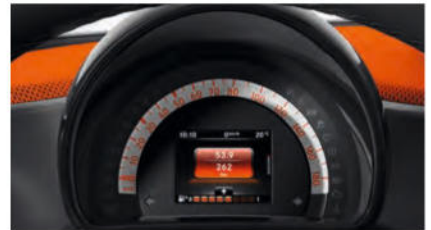
Kombiinstrument mit farbigem 8,9 cm (3,5") Display in TFT-Technologie und Bordcomputer [K36]
