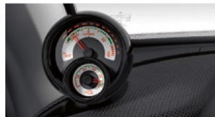
Zusatzinstrument (Batterieladezustands- und Leistungsanzeige) [V31]
