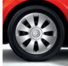
Stahlräder mit Radzierblenden mit Bereifung vorn 165/65 R 15, hinten 185/60 R 15 [R83]
