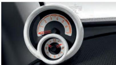
Zusatzinstrument mit Cockpituhr und Drehzahlmesser [V31]
