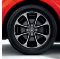
Leichtmetallräder im 8-Speichen-Design in schwarz lackiert und glanzgedreht mit Bereifung vorn 165/65 R 15, hinten 185/60 R 15 [R86]
