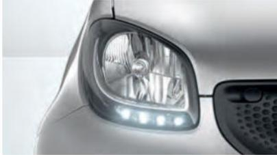
H4-Halogencheinwerfer mit integriertem Tagfahrlicht in LED-Technik<sup>1</sup>
