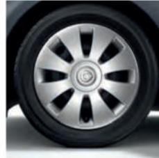
Stahlräder mit Radzierblenden mit Bereifung vorn 165/65 R 15, hinten 185/60 R 15 [R83]
