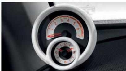
Zusatzinstrument mit Cockpituhr und Drehzahlmesser [V31]
