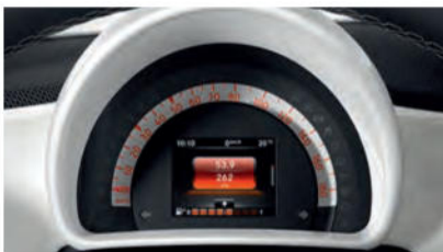
Kombiinstrument mit farbigem Display 8,9 cm (3,5") in TFT-Technologie und Bordcomputer
