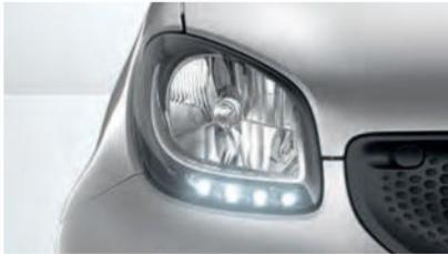
H4-Halogencheinwerfer mit integriertem Tagfahrlicht in LED-Technik<sup>1</sup>
