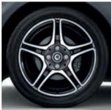
Leichtmetallräder im 5-Doppelspeichen-Design in Schwarz lackiert und glanzgedreht mit Bereifung vorn 185/50 R 16, hinten 205/45 R 16 [R91]<sup>1</sup>
