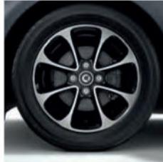
Leichtmetallräder im 8-Speichen-Design in Schwarz lackiert und glanzgedreht mit Bereifung vorn 165/65 R 15, hinten 185/60 R 15 [R86]
