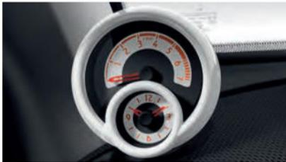
Zusatzinstrument mit Cockpituhr und Drehzahlmesser [V31]
