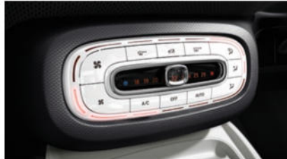
Klimatisierungsautomatik mit automatischer Temperaturregelung [I01]
