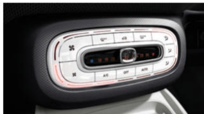
Klimatisierungsautomatik mit automatischer Temperaturregelung [I01]
