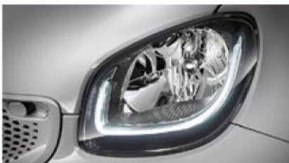
H4-Halogencheinwerfer mit Welcome-Funktion und integriertem Tagfahrlicht in LED-Lichtleiter-Technik [K32]
