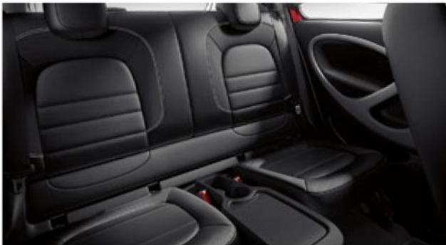
readyspace Sitze hinten mit entnehmbarem Cargobox, Fondsitzelehnen klappbar 50:50 geteilt und Cargo-Stellung (forfour) [S33]
