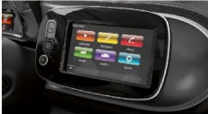
smart Media-System mit 17,8 cm (7") Multi-Touch-Display in TFT-Technologie [535]
