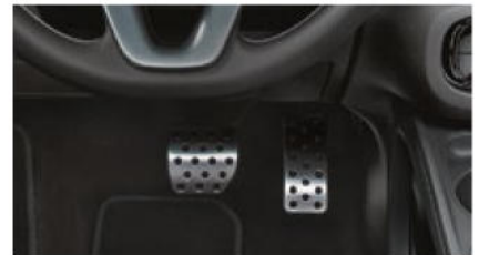
Sportpedalanlage aus gebürstetem Edelstahl mit Gumminoppen
