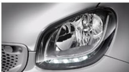
H4-Halogencheinwerfer mit integriertem Tagfahrlicht in LED-Technik
