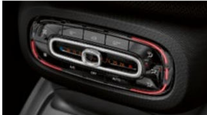
Klimatisierungsautomatik mit automatischer Temperaturregelung [I01]
