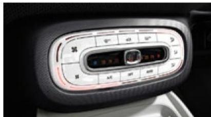
Klimatisierungsautomatik mit automatischer Temperaturregelung [I01]
