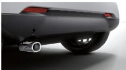
Abgasanlage mit verchromter Endrohrblende
