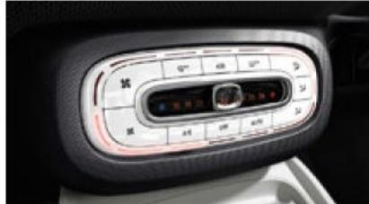
Klimatisierungsautomatik mit automatischer Temperaturregelung [I01]
