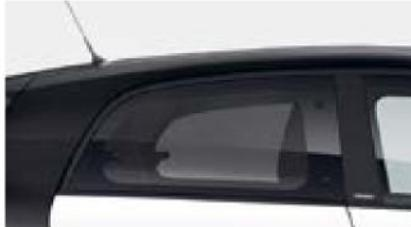
Wärmedämmendes, dunkel getöntes Glas für hintere Seitenfenster und Heckscheibe (forfour) [E21]
