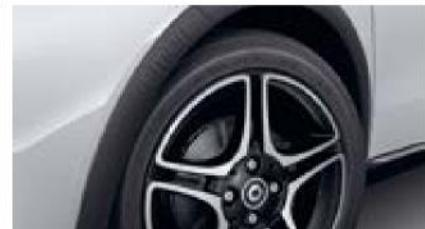
40,6 cm (16") Leichtmetallräder im 5-Doppelspeichen-Design in schwarz lackiert und glanzgedreht, mit Bereifung vorn 185/50 R 16, hinten 205/45 R 16 [R91], Radlaufverkleidungen mit smart Schriftzug [E84]
