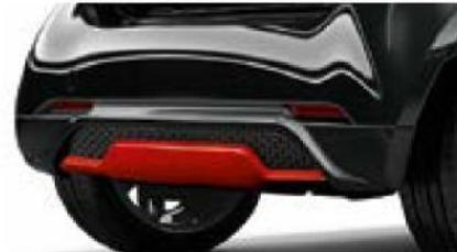
BRABUS Heckschürze mit Diffusor für Serienabgasanlage
