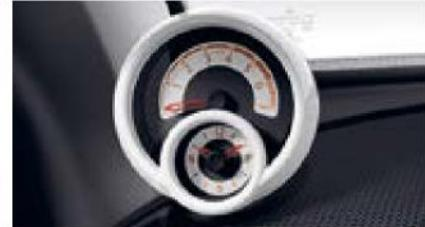
Zusatzinstrument mit Cockpituhr und Drehzahlmesser [V31]
