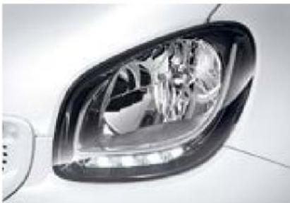
H4-Halogencheinwerfer mit integriertem Tagfahrlicht in LED-Technik
