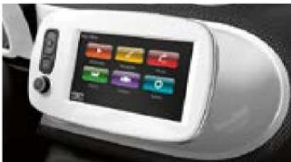
smart Media-System mit 17,8 cm (7") Multi-Touch-Display in TFT-Technologie [535]
