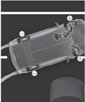
**Antiblockiersystem (ABS) mit elektronischer Bremskraftverteilung (EBD)**
