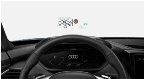
Auf Wunsch werden die Geschwindigkeit und weitere fahrerrelevante Informationen aus optional erhältlichen Ausstattungen wie Assistenzsystemen sowie Navigationshinweise und Warnhinweise in den direkten Sichtbereich des Fahrers projiziert. Die Blickabwendung von der Fahrbahn wird dadurch reduziert. Die mehrfarbige Anzeige ermöglicht eine kontraststarke Darstellung. Die Projektionsfläche des dezent in die Instrumententafel integrierten Head-up Displays ist in der Höhe und Helligkeit einstellbar.
