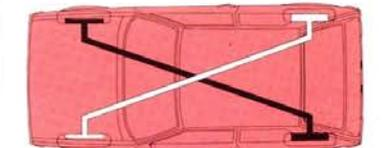
Die zwei Bremskreise des Audi 50 sind über Kreuz angeordnet. So wird bei Ausfall eines Kreises noch je ein Vorder- und Hinterrad gebremst.
