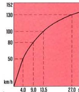
Die Beschleunigungswerte des Audi 50 zeigen seine Spurtstärke und Überholstärke. In nur 13,5 sec ist der Audi 50 GLS auf 100 km/h. Der Audi 50 LS: Von 0 auf 100 km/h in 15,4 sec.
