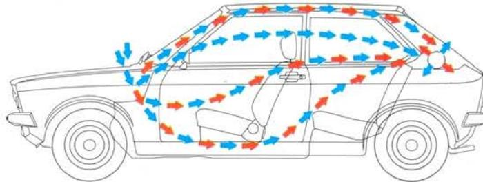
Die wirksame Belüftungs- und Heizanlage des Audi 50. Mit ihrer großen Leistung sorgt sie dafür, daß bei kalter, feuchter Witterung alle Scheiben schnell beschlagfrei werden. Die Luft
