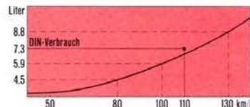
Der DIN-Verbrauch beträgt beim Audi 50 LS mit 50-PS-Motor 7,6 Liter Normalbenzin, beim Audi 50 GLS mit 60-PS-Motor 7,3 Liter Superbenzin auf 100 Kilometer.
