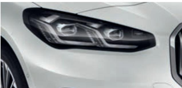
□ Die Adaptiven LED-Scheinwerfer im attraktiven Vier-Augen-Design verfügen über dynamische Lichtfunktionen sowie einen blendfreien Fernlichtassistenten (Bestandteil des Premium Pakets und Innovationspakets).
