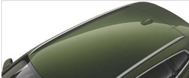
□ Die flach aufliegende Dachreling aus satiniertem Aluminium ist harmonisch auf das Fahrzeugdesign abgestimmt, akzentuiert die Dachlinie und dient als Basis für eine multifunktionale BMW Dachträgereinheit, die Dachboxen, Fahrräder, Surfbretter etc. sicher aufnimmt.
