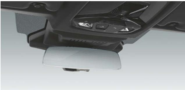
■ Innen- und Außenspiegelpaket, u. a. mit automatisch abblendendem Innen- und Fahreraußenspiegel sowie elektrischer Anklappfunktion für Außenspiegel.
