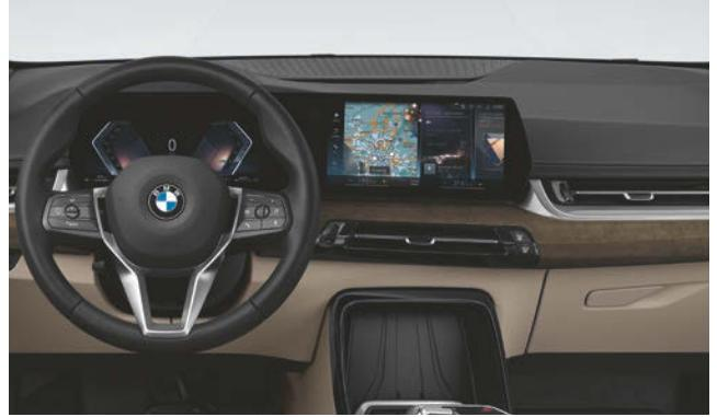
■ Das BMW Curved Display paart eine intuitive Bedienung mit einem Anzeigenverbund aus 10,25" Instrumentendisplay und 10,70" Control Display.
